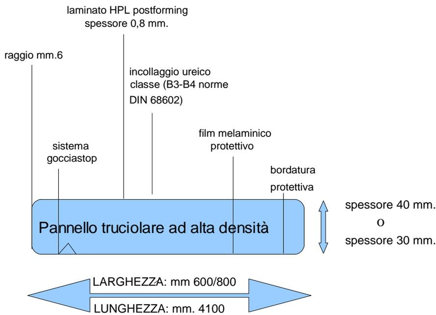
Spessore: mm. 30 (PQ3) quadra profil SPESSORE mm. 30
